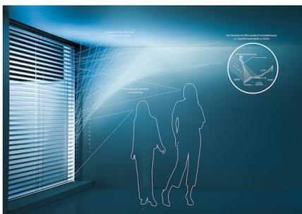
*Der intelligente Tageslichtraffstore von Schlotterer vereint Hitzeschutz, Blendschutz, Tageslichtnutzung und Durchsicht. Konventionelle Sonnenschutzsysteme verdunkeln die Räume, das Tageslicht wird ausgesperrt. Der Tageslichtraffstore RETROLux sorgt hingegen für einen tageslichtdurchfluteten Raum mit blendfreier Durchsicht nach draußen.*
